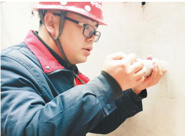
▲曹磊在施工现场对底板梁进行回弹度试验。
